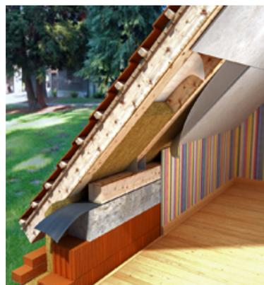
Если высота стропил не позволяет уложить требуемую толщину слоя теплоизоляции и оставить воздушный зазор, то можно сделать 2х-слойное решение, уложив часть утеплителя изнутри по дополнительному каркасу, набитому по стропилам.
